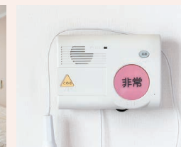
緊急通報装置
